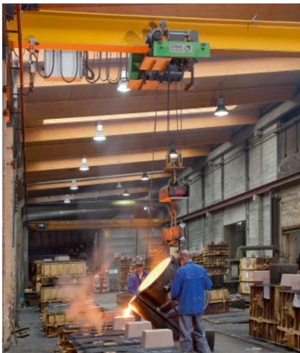
1 На современном механизированном литейном производстве для изготовления высокопрочных деталей работает однобалочный опорный кран с канатным механизмом подъема SH 40. Механизм подъема имеет грузоподъемность 4.000 кг и оснащен теплозащитными экранами.
