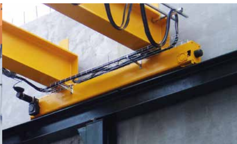
Концевые балки для двухбалочных передвижных мостовых кранов
