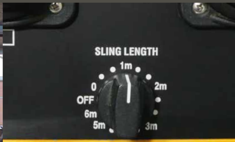
Переключатель для ввода дополнительной длины троса
