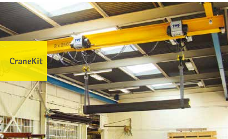
Однобалочный подвесной передвижной кран
