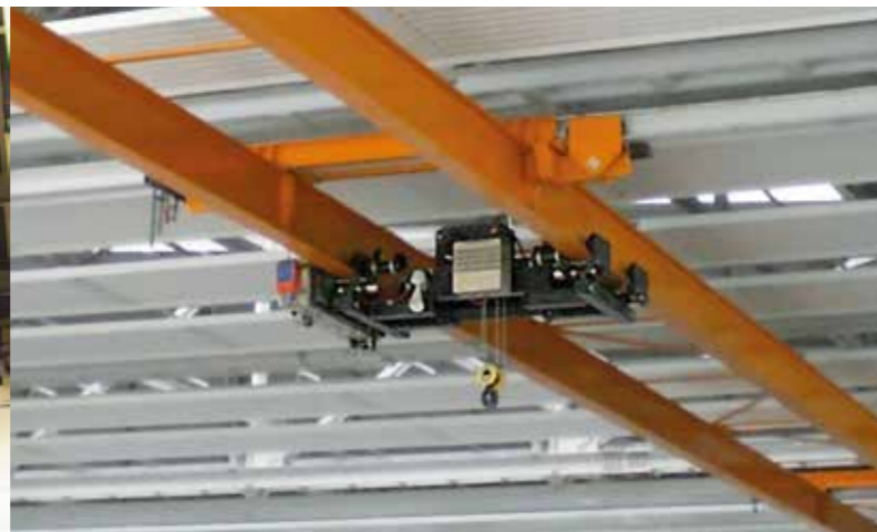
Двухбалочный подвесной передвижной кран
