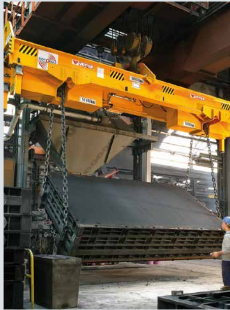
Tragfähigkeit / Capacity: 100 t Bandabstand / Belt distance: 2900 - 7000 mm Seitenverstellung / Adjustment: elektrisch / electrical
