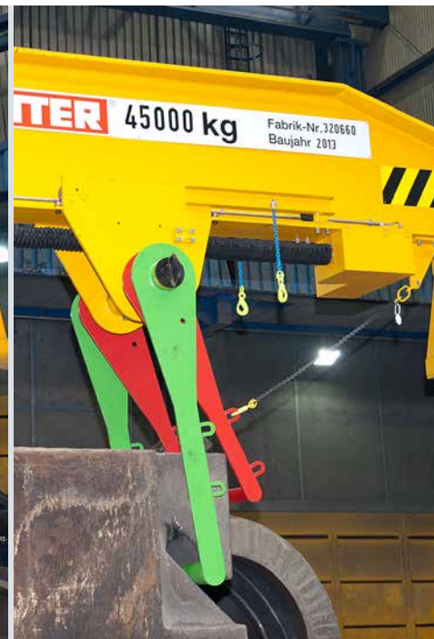
Abb. 2: Aufnahmemulde mit Bügel Fig. 2: Recess with bracket
