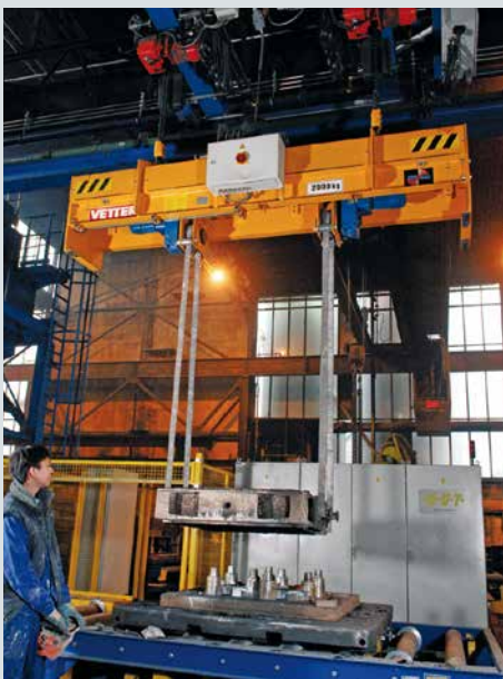
Tragfähigkeit / Capacity: 2 t Bandabstand / Belt distance: 900 - 2000 mm Seitenverstellung / Adjustment: elektrisch / electrical
