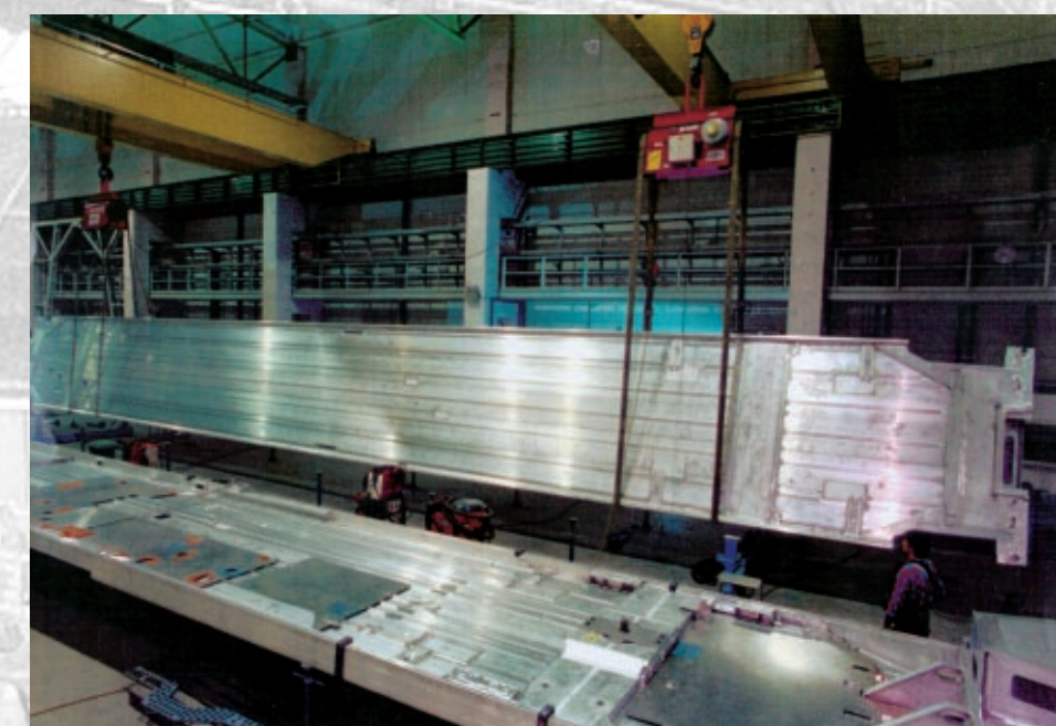
2 ROTOMAX® COMPACT 10 000 beim Wenden einer ICE-Bodengruppe 2 ROTOMAX® COMPACT 10 000 rotating ICE coach floors 2 ROTOMAX® COMPACT 10 000 pour le retournement d'un plancher d'ICE
