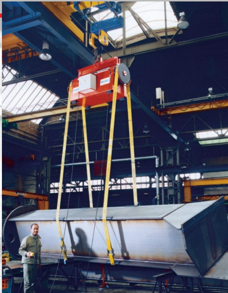
ROTOMAX® COMPACT 10 000 beim Drehen einer Schweißkonstruktion ROTOMAX® COMPACT 10 000 turning a welding workpiece ROTOMAX® COMPACT 10 000 pour le retournement d'une construction soudée
