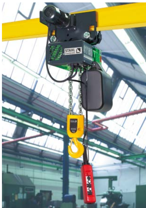
Стандартная цепная таль с электрическим ходовым механизмом.
