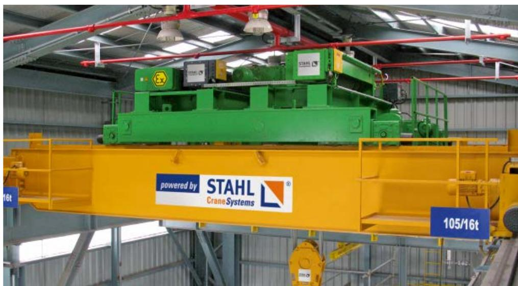
Взрывозащищенные канатные тали со вспомогательным подъемом в двойном исполнении для проведения работ по техническому обслуживанию компрессоров на одном из заводов по сжижению водорода.
