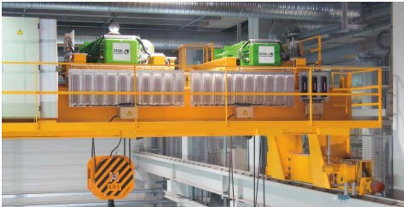
Для надежной работы по проведению техобслуживания канатный подъемный механизм AS7 оснащен обслуживающей площадкой. Двурогий подъемный крюк крюковой подвески поворачивается электрически для возможности проведения точной манипуляции с грузом.
